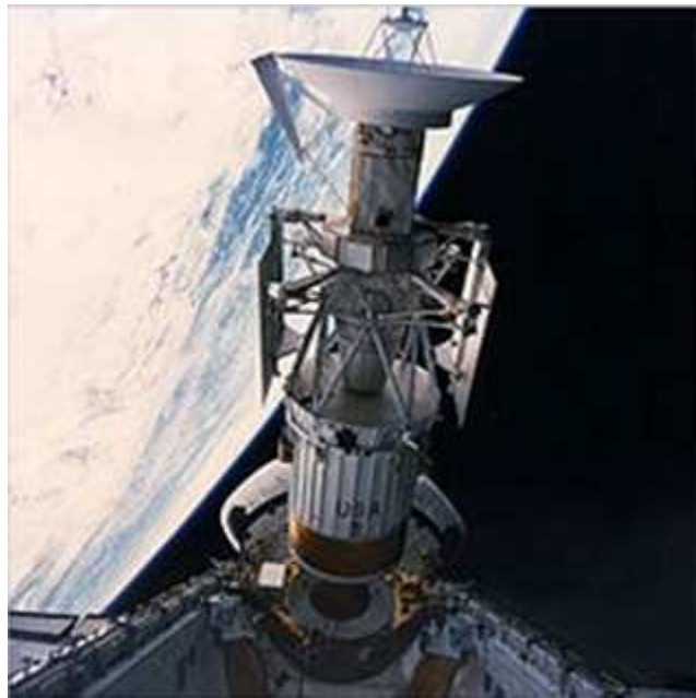
La sonde Magellan accouplée avec l'étage IUS est extraite de la soute de la navette spatiale.
